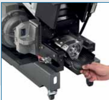
Gehärtete Messer und Siebe als Standard
