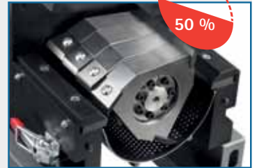
Siebfläche entspricht 50% des Schneidkreises Absaugkasten mit integriertem Siebhalter
