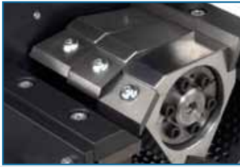
Einstellbare Gegenmesser; Einwegrotormesser
