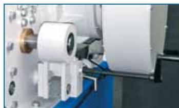
Öffnung des Siebhalters mit manueller Winde
