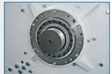
Pendelrollenlager mit Druckbuchsen, gusseiserne Aufnahmen
