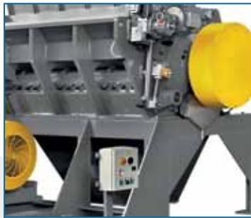
Öffnung des Fülltrichters mit motorisierter Winde
