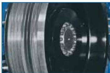
Expansionsstopfen zur Befestigung der Antriebscheibe und des Schwungrads
