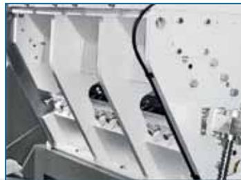
Zusammenbau der Mahlkammer mit erster verschleißfester Querstange
