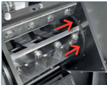
Mitlaufende Seitenscheiben, auf dem Rotor befestigt
