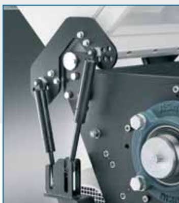
Öffnung des Trichters unterstützt von Gasdruckdämpfern
