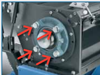
Lagerung direkt an der Mahlkammer befestigt
