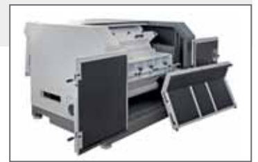
Wartung und Reinigung an nur einer Seite ohne Kippen von Komponenten
