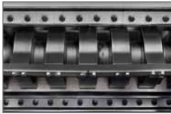
V-Rotor mit Scherenschnitt
